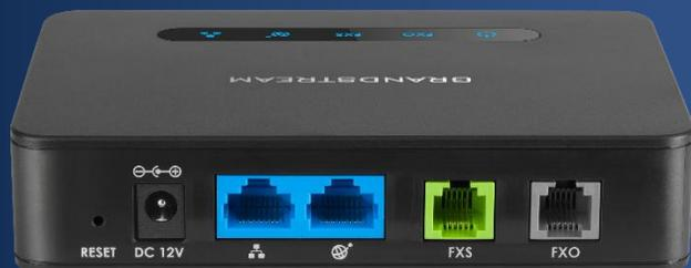
HT813は、PSTN回線の利用によるライフラインの確保をサポートを可能にするアナログ電話機用のFXSポート1系統とPSTN回線FXOポート1系統を装備するアナログ電話アダプタです。FXOとFXSの両ポートの統合により、VoIP-to-PSTNまたはPSTN-to-VoIPコールによるPSTN回線とVoIP間に於けるリモートによる発話と終話の機能を提供します。1系統のFXSポートは、VoIPサービスを1台のアナログ電話機に拡張することを可能にします。
